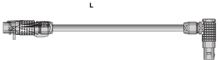
Bei Steckern mit Knickschutztülle aus Gummi, ist es die hintere Spannmutter. Die Stecker werden nicht zur Kabellänge hinzugerechnet.
